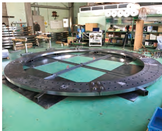
アンカーリング
